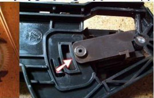
Są 4 zaczepy bocznych ścianek (3 widoczne od środka a 4 jest schowany za zespołem zaworów).
